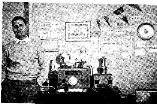
Het station HB9EU. Links de operator, OM Faessler. De zender is elders geplaatst en wordt op afstand bediend. Op de foto ziet u naast de ontvanger de apparatuur voor de afstand-bediening. (foto: Albert Scheidegger, Steinhausen, Zwitserland)
